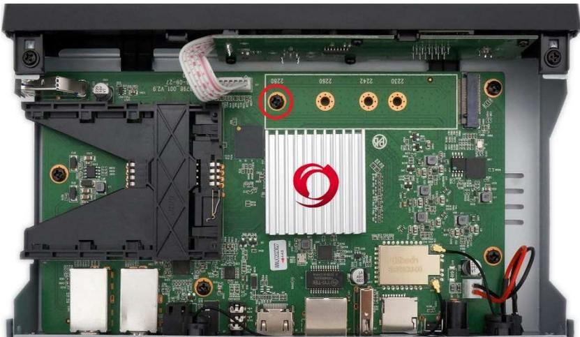
3. Setzen Sie die M.2-SSD im 30-Grad-Winkel in den entsprechenden Steckplatz ein. Drücken Sie die gegenüberliegende Seite nach unten und befestigen Sie die Festplatte mit der zuvor entfernten Schraube
