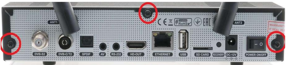
2. Entfernen Sie die rot markierte Schraube
